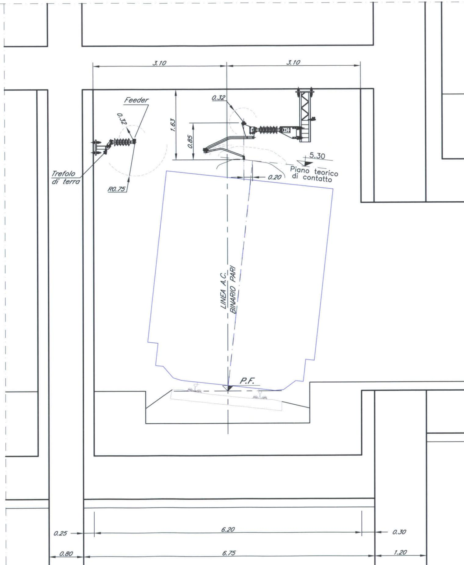
Sezione tipo per galleria artificiale da inizio tratta fino ad Orbassano
