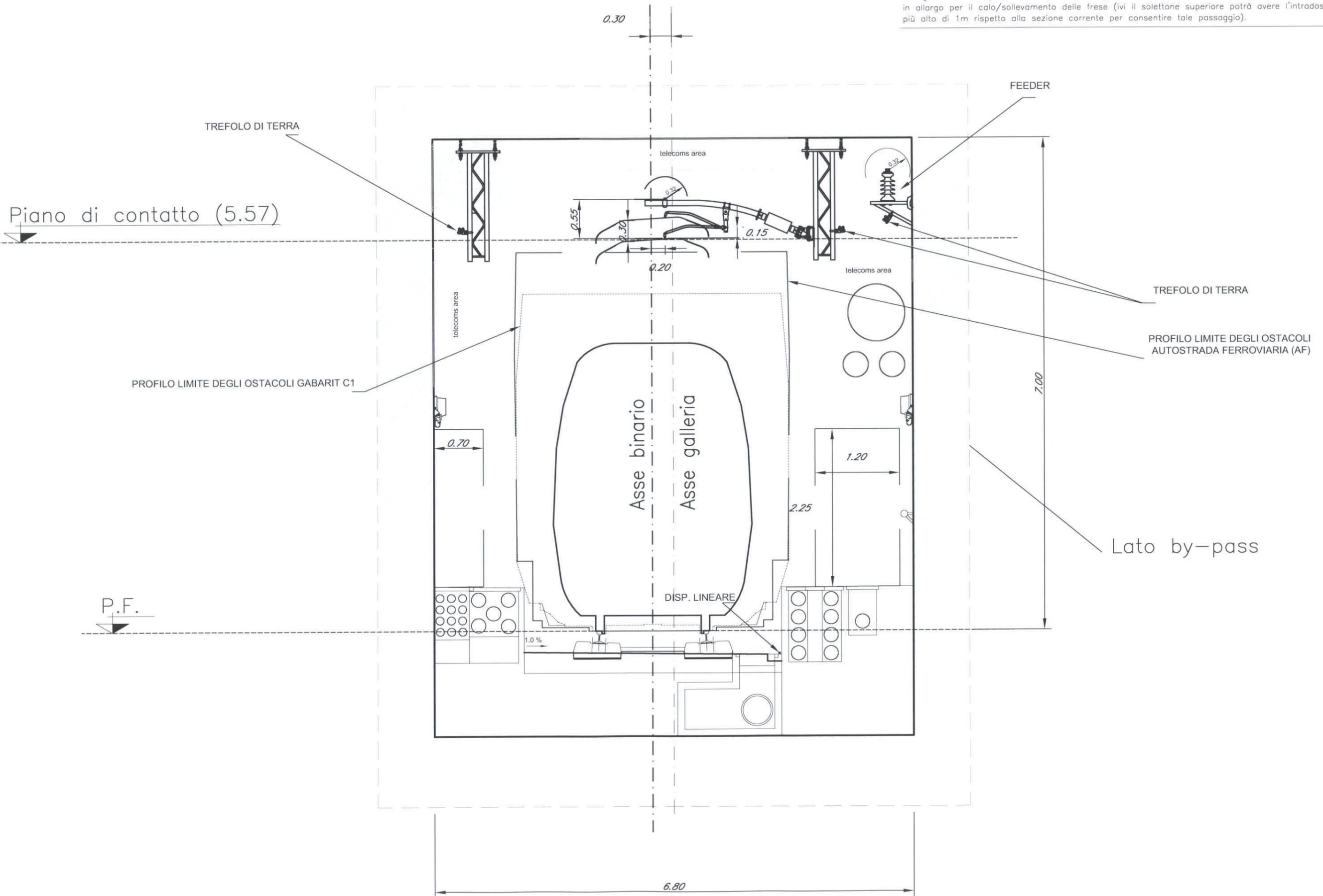
Sezione tipo per galleria artificiale da inizio tratta fino ad Orbassano
