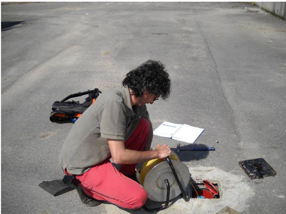
*Foto 6: lettura dei piezometri Norton e Casagrande.*
