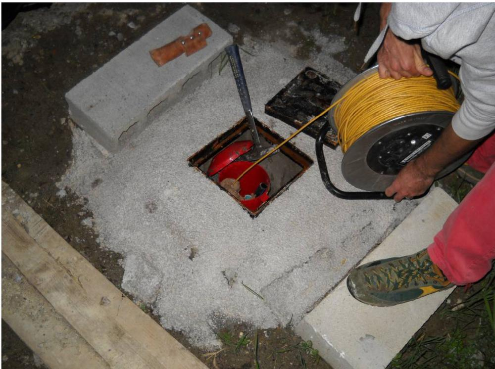
*Foto 2: misura del livello piezometrico con freatimetro*
